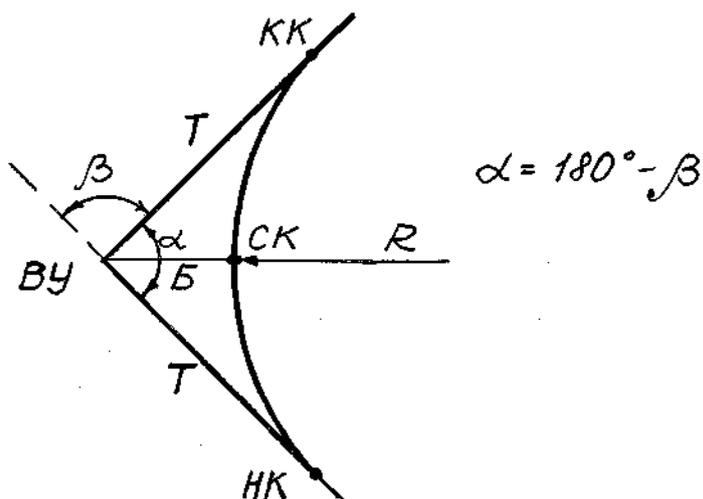
Рисунок 4 – Схема элементов круговой кривой
