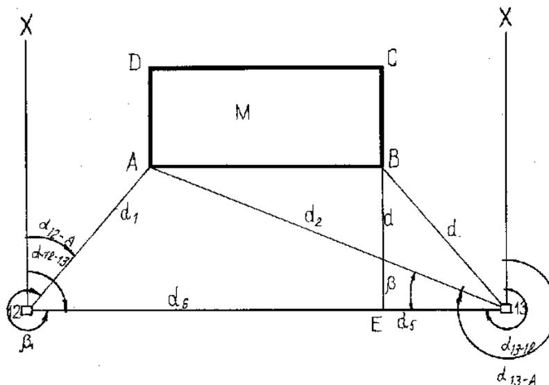
на плоскости, определяют расстояния  $d_3$ ,  $d_4$ ,  $d_5$  и  $d_6$ . Расстояния  $d_4$  и  $d_6$  необходимы для контроля разбивки – выноса в натуру точки В.
